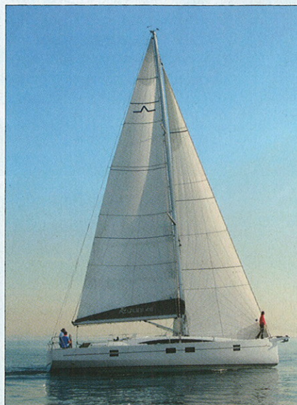
▲ Géo à faible recouvrement mais grande GV très élancée : c'est ça un gréement moderne!
